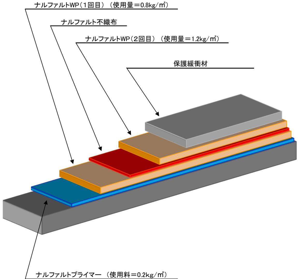
ナルファルト塗膜シート地下外壁密着工法 NWW-Y01-PM工法
