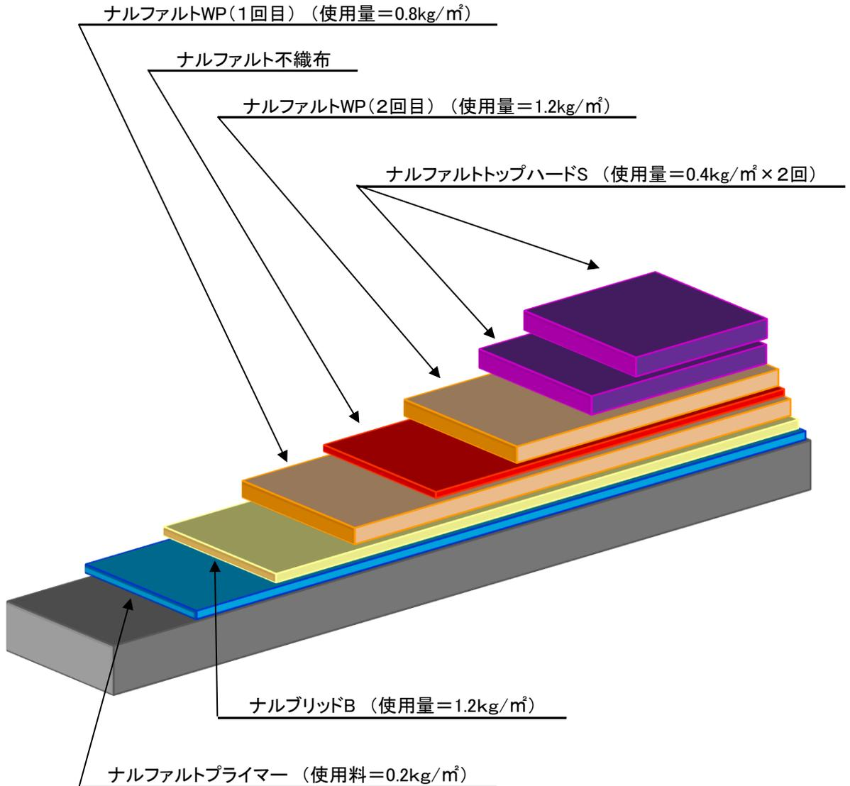
ナルファルト塗膜シート軽歩行露出絶縁(高耐久防滑)工法 NWW-X01-HS工法
